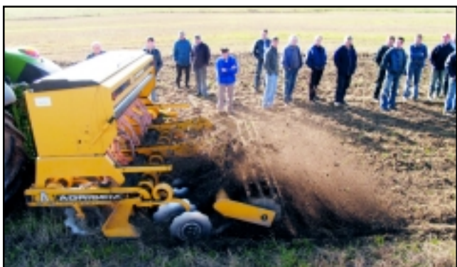
„Agrisem“ paviršinis parentuvus įdirba žemę ir tuo pačiu metu gali sėti.
