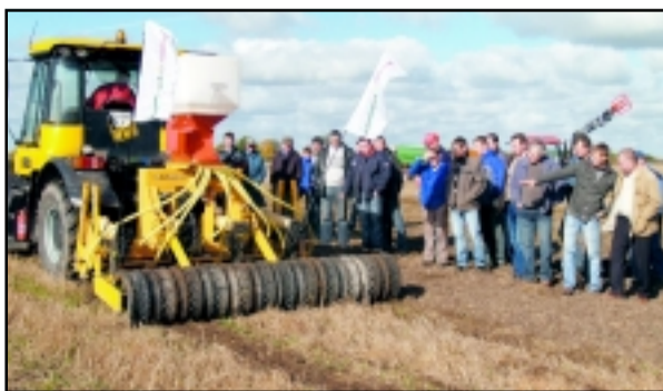
Iki 40 cm gylio žemę įdirbantys „Agrisem“ parentuvus palieka vos pastebimą pėdsaką, todėl juo galima „arti“ ir tuoj po sėjos.
